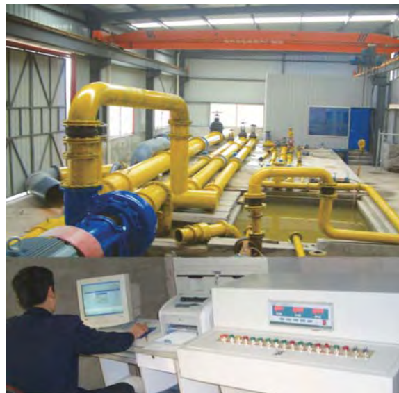
▲ 8000m 3 /h泵全性能测试台
