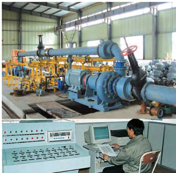
▲ 2000m 3 /h泵全性能测试台
